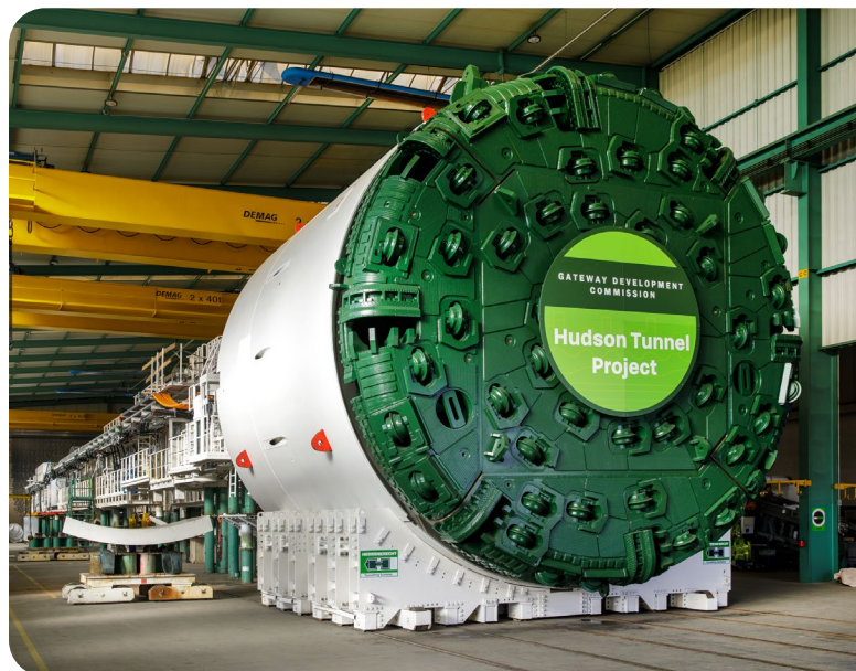
Las máquinas tuneladoras excavarán la sección del túnel que parte desde New Jersey hasta la orilla de Manhattan
