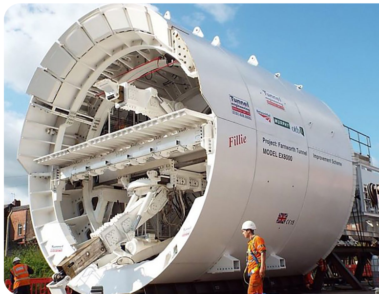
Escudo para una de las TBM que perforará el nuevo túnel
